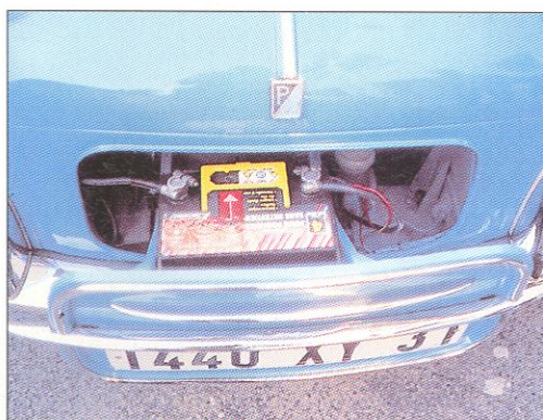
Pratique mais très exposée, la batterie apparaît derrière la calandre montée sur glissières.
