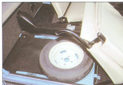
La roue de secours se trouve adroitement glissée sous le siège du passager.
